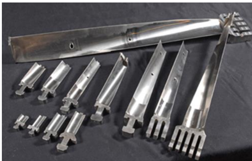
Рис. 2 – Приклад набору робочих лопаток ротору турбіни з «молоточковим» та «виделковим» типом хвостовика
