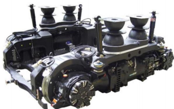
Рис. 15 – Візок низькопідлогового трамваю Combino моделі SF30: а – загальний вигляд візка; б – кріплення редуктора до рами візка
