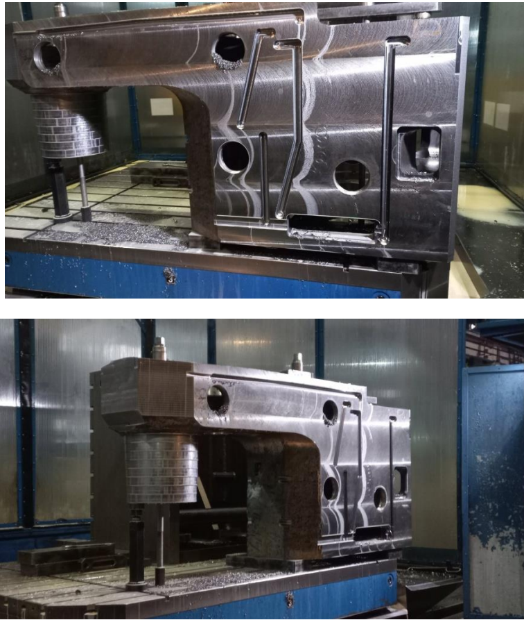
Рис. 5 – Обробка корпусу різання на верстаті з ЧПК TOS Varndorf
