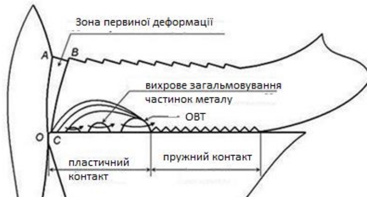
Рис. 1 – Схема, що демонструє механізм тертя при високошвидкісному зубофрезеруванні
