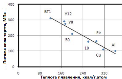
Рис. 6 – Залежність питомої сили тертя від питомої теплової енергії плавлення в умовах V = 100 м/хв, S = 0,157 мм/об
