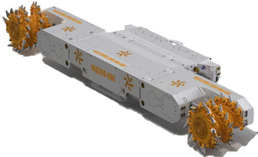
Рис. 1 – Очисний комбайн УКД200-500
