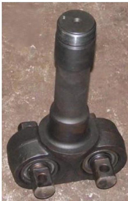
Рис. 7 – Універсальний кронштейн з гумометалевими шарнірами
