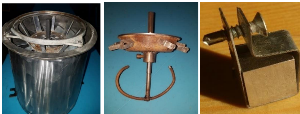
Рис. 3 – Установка для іспитів (а); ротор (б); утримувач зразків (в)
