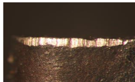
б) після електроерозійного шліфування ( h_3=0,4 мм при T=84 хв)
