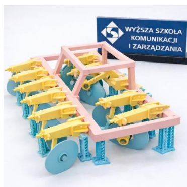
Рис. 5 – Фізичний макет, виготовлений методом 3D-друк
