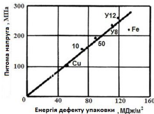
Рис. 5 – Графік зміни питомої сили тертя залежно від параметра E_d в умовах високошвидкісної обробки (режим: V = 100 м/хв; S = 0,161 мм/об)
