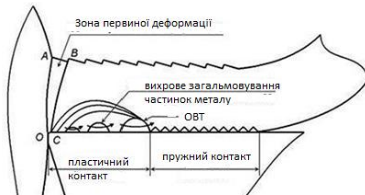
Рис. 1 – Схема, що демонструє механізм тертя при високошвидкісному зубофрезеруванні
