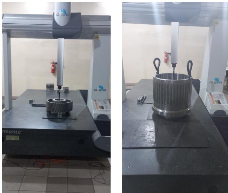
Рис. 8 – Контроль деталей на вимірювальній машині GLOBAL12.22.10
