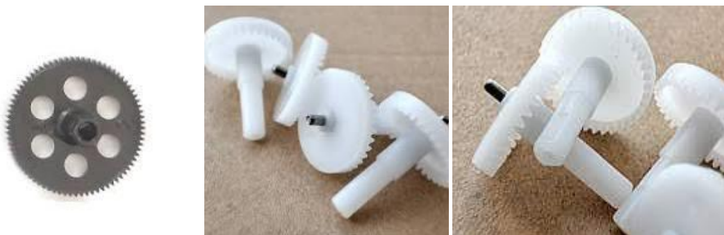
Рис. 2 –Привідні шестерні з асиметричним профілем зубів безпілотних літальних апаратів (БПЛА)
