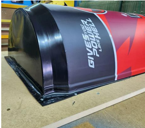
Рис.3 – Установка и закріплення заготовки деталі «Панель задня» на спеціальному пристрою
