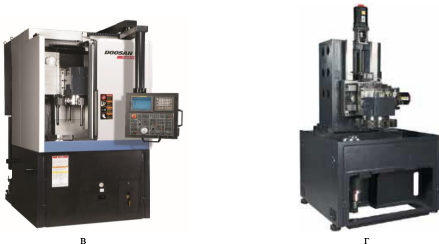
Рис. 6. Деталь «Чашка міжколісного диференціала» (а), вертикальний токарний обробний центр PUMA V400L (б), вертикальний токарний обробний центр із фрезерною функцією PUMA V400ML (в) та горизонтальний фрезерний обробний центр DOOSAN HC 400 (г)
