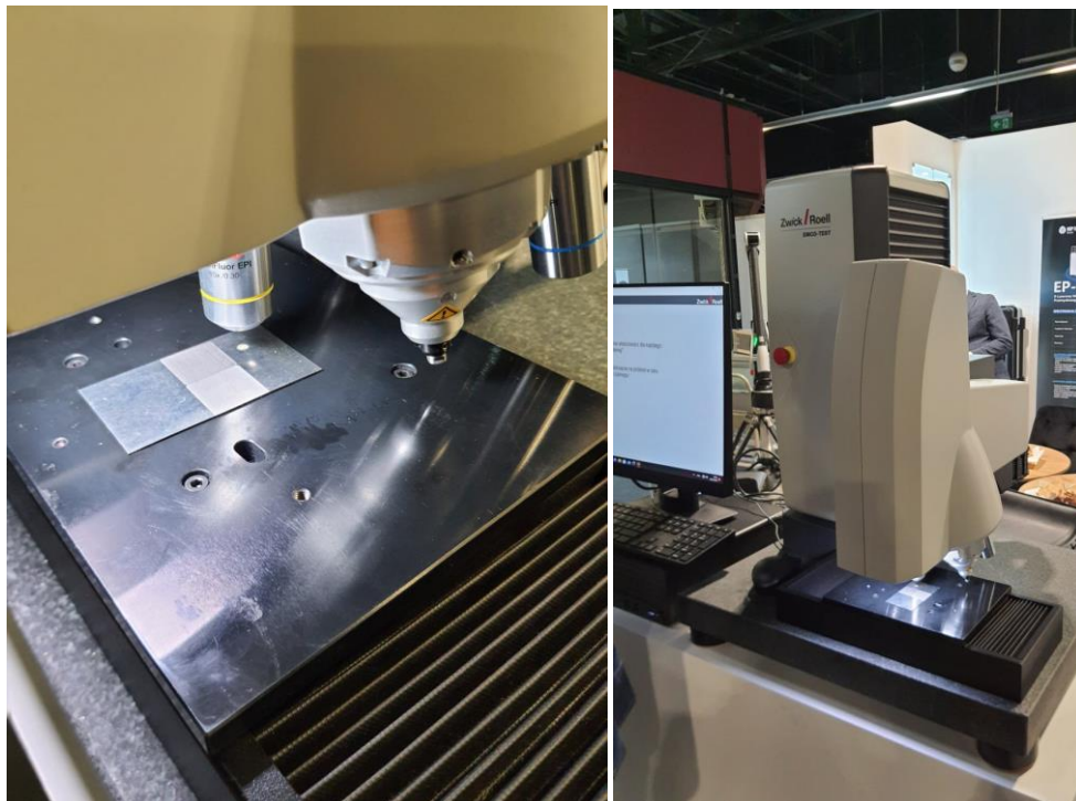
Рисунок 1 – Твердомір за Віккерсом фірми ZwickRoell із зразками досліджуваної сталі AISI 321
