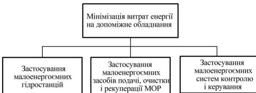
Рис. 3 – Структура системи заходів по мінімізації енерговитрат на допоміжне обладнання
