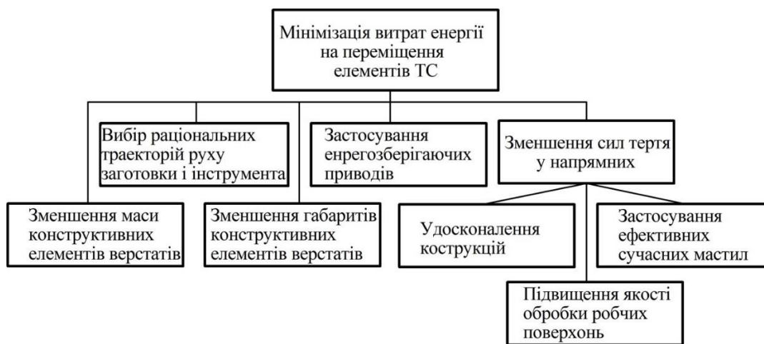
Рис. 2 – Структура системи заходів по мінімізації енерговитрат на переміщення елементів технологічної системи
