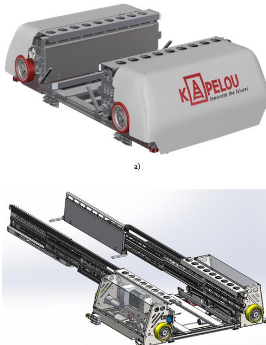
Рис. 1 – Загальний вигляд (а) та внутрішня будова (б) шатла (мобільного робота) для внутрішньо-складського транспортування проміж рядами стелажів, запропонованого фірмою Karpelou [3]
