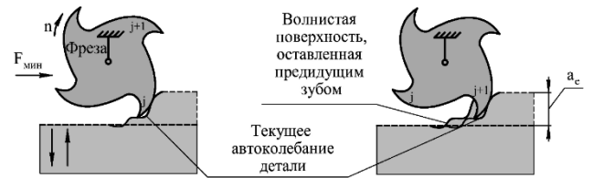
Рис. 2 – Формирование обработанной поверхности тонкостенной детали в условиях регенеративных автоколебаний
