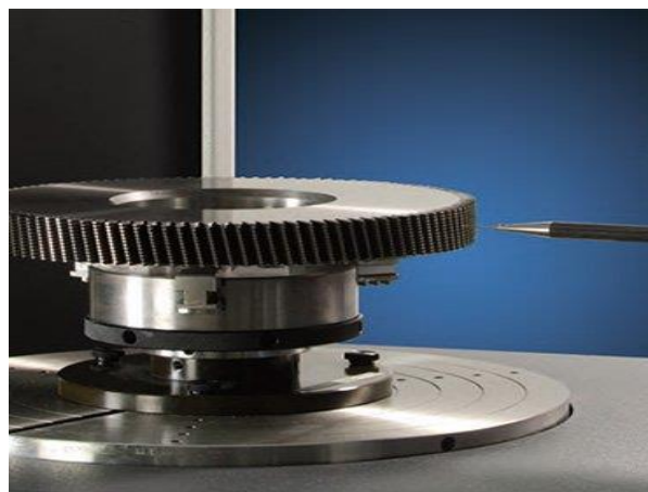
Рис. 3 – Сканирование волнистости боковой поверхности зуба по профилю на зубоизмерительной машине MarGear GMX 275
