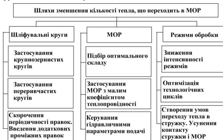
Рис. 6 – Шляхи зниження теплового впливу на МОР при шліфуванні
