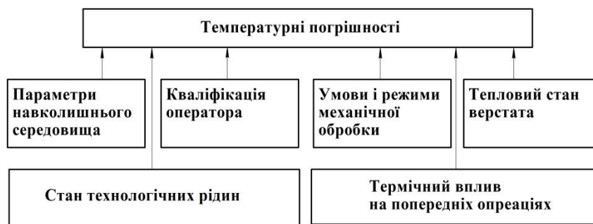
Рис. 1 – Фактори, що викликають температурні погрішності при механічній обробці на верстатах
