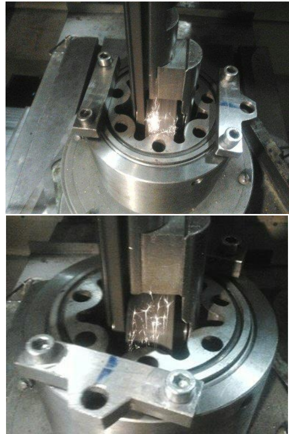
Рис. 8 – Процес шліфування внутрішнього профілю цівкового колеса в умовах планетарного обкату: а – кругом з випуклою формою профілю; б – кругом з увігнутою формою профілю
