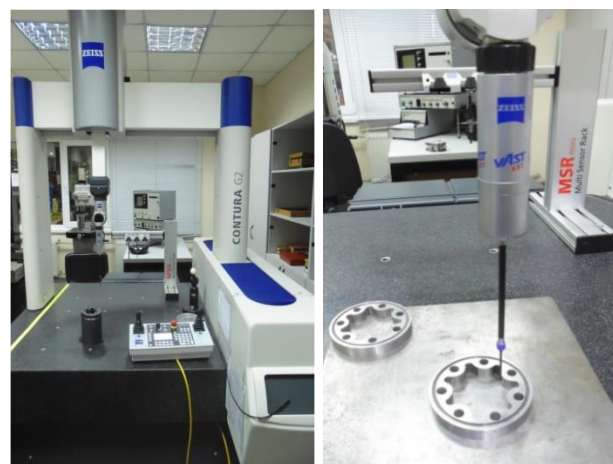
Рис. 9 – Вимірювання параметрів цівкового колеса на координатно-вимірвальній машині Contura G2 (Carl Zeiss)
