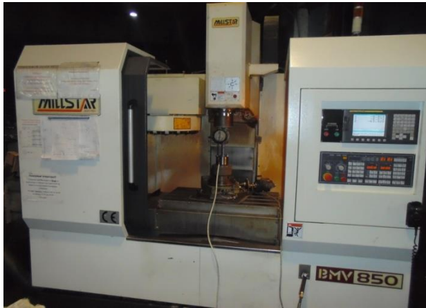
Рис. 3 – Обробний центр з ЧПУ моделі BMV-850 MILLSTAR, оснащений пристосуванням для профільного шліфування внутрішніх поверхонь і пристосуванням для відтворення руху обкату
