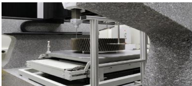
Рис. 2 – Вимірювання крупномодульного зубчастого колеса на координатно-вимірювальній машині зі спеціальним модулем
