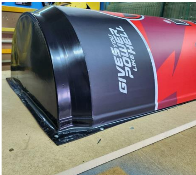
Рис.3 – Установка и закріплення заготовки деталі
