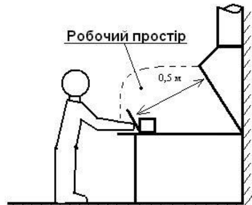
Рис.3 - Витяжна вентиляція (зонт) на робочому місці зварювальника
